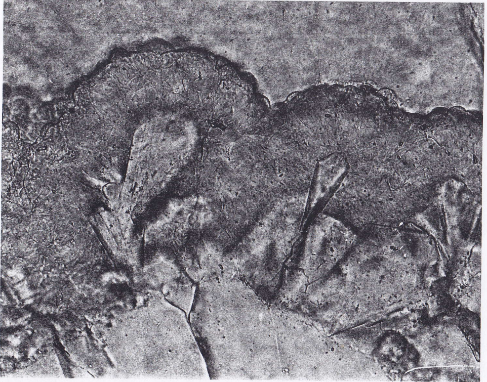
Abb. 1: Tridymitwillinge nach (1016), von kollomorphem Cristobalit umschlossen, aus Rhyolithkugel M 1:500, 1 Polarisator
